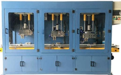
استفاده از سرو موتور سه محوره برای هد جوشکاری
